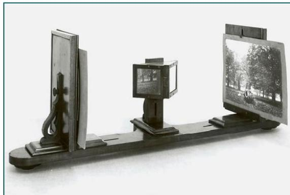
Figura 1. Estereoscopio diseñado por Wheatstone. (Cabezos, 2014).
