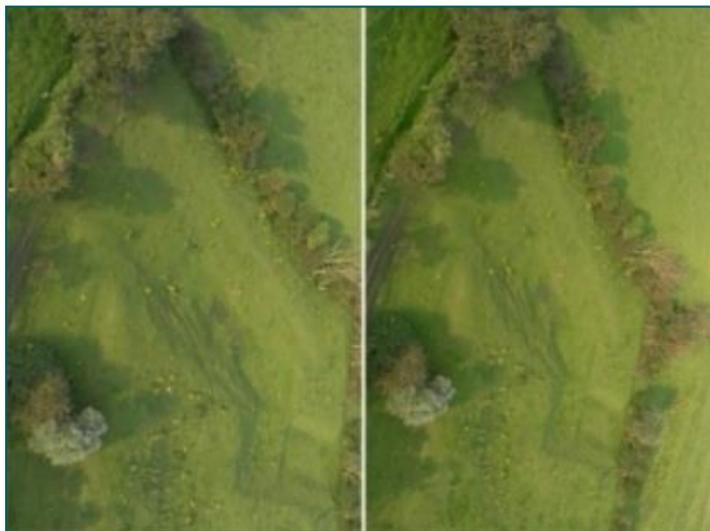
Figura 13. Par estereoscópico de una foto aérea.<sup>10</sup>
