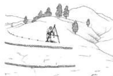
Trazando una zanja de coronación con 1% de caída.
