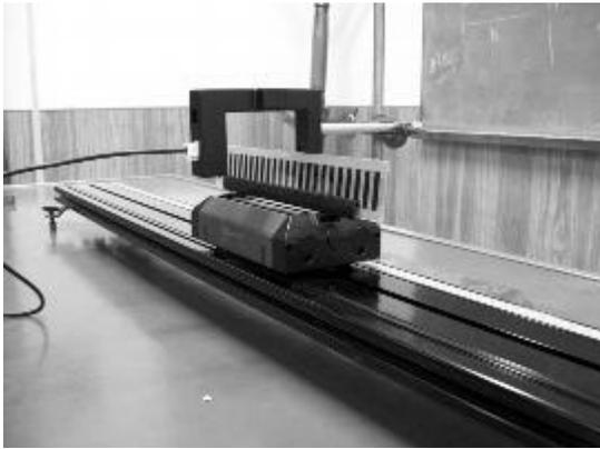
Figura 1. Arreglo experimental para estudiar el movimiento del carro.
