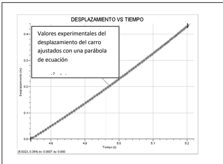
*Figura 3.* Representación gráfica de los valores experimentales de los desplazamientos  $D_i$  de las bandas negras respecto de la banda inicial, para cada tiempo  $t_i$ , correspondiente a un movimiento uniformemente acelerado. Se observa un arco de parábola con concavidad hacia arriba.
