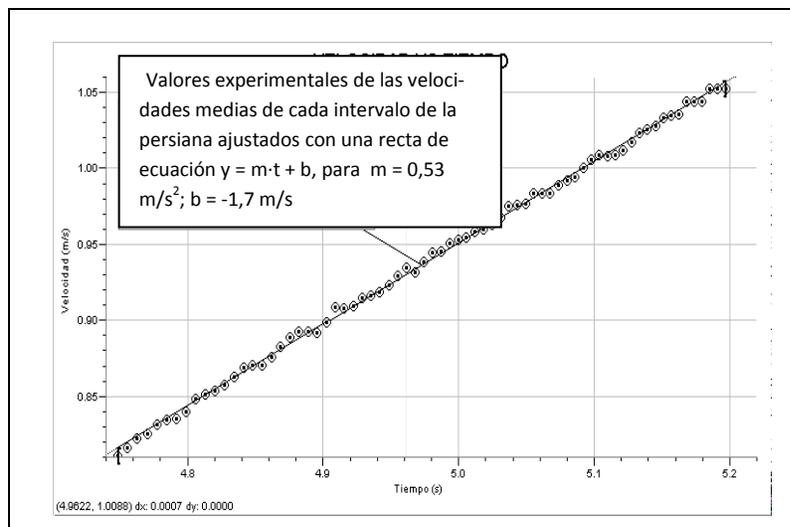
Figura 2. Representación de los valores de las velocidades medias correspondientes a cada intervalo de tiempo  $t_i, t_i + \Delta t_i$ , ajustados con una recta de pendiente positiva, según el movimiento experimentado por el carro. La ecuación de la recta de ajuste está indicada en el borde superior, donde  $m = 0,53$  es la pendiente,  $b = -1,73$  es la ordenada al origen.
