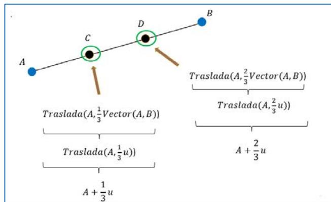
Figura 5. Comando Traslada para dividir segmento  $AB$
