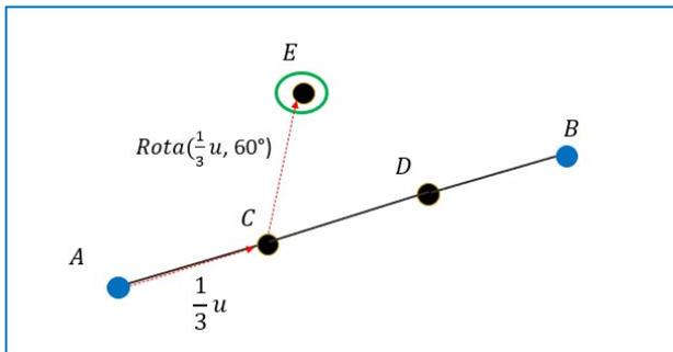
Figura 6. Comando Rota para determinar el vértice  $E$
