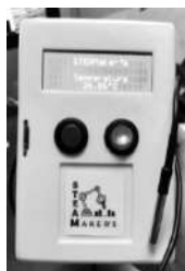
Figura 1. Sensor de temperatura sumergible. Fuente propia.
