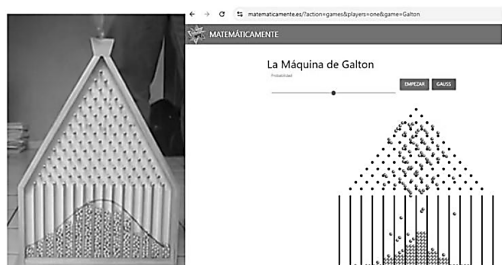
Figura 1. Máquina de Galton (física y simulada)
